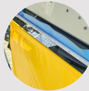
• **La chiusura e l'apertura sincronizzate degli scivoli** con lo scarico delle benne, eliminano le perdite ed un rispetto maggiore della vasca in fase di scarico. La vasca non viene toccata dallo scivolo. Il materiale più elastico garantisce uno scivolamento con meno attrito del prodotto nelle vasche.
